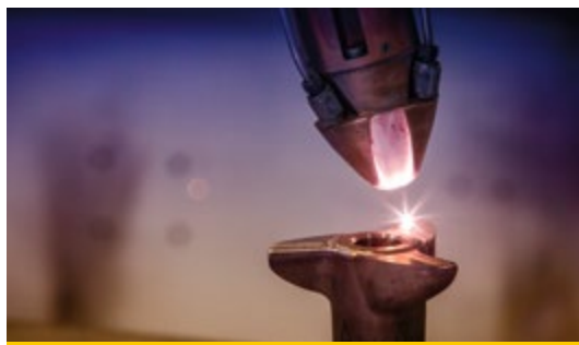
Verschleißbeständige Schneidkante wird aufgeschweißt A wear-resistant cutting edge is welded on
